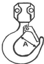
Remplacer le crochet lorsque « A » dépasse **25.2 mm**.
